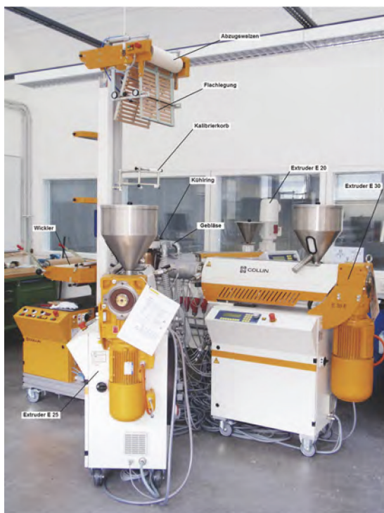
Blacfolienanlage im Labor
